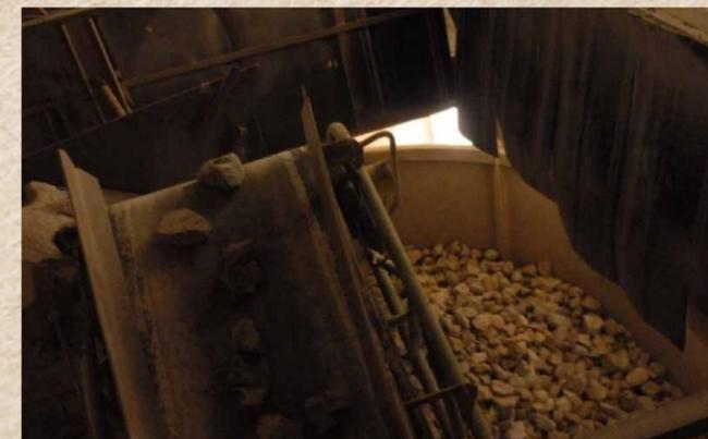
Hier liegen ganz viele unterschiedlich große Siebe übereinander und sortieren so die Steine nach Größen. Die verschiedenen großen Steine werden in unterschiedliche Silos und anschließend auf Halden eingelagert.
